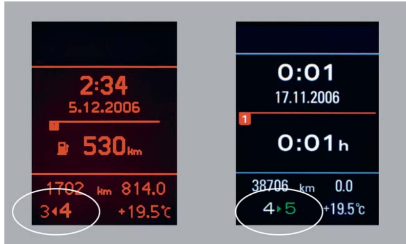
Hochschaltanzeige im Midline- bzw. Highline-Kombi
