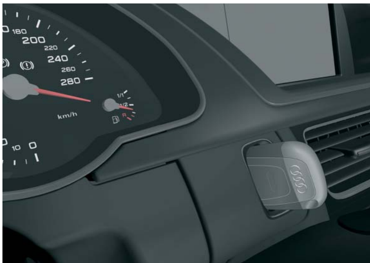
Gesteckter Schlüssel im Elektronischen Zündschlossmodul
